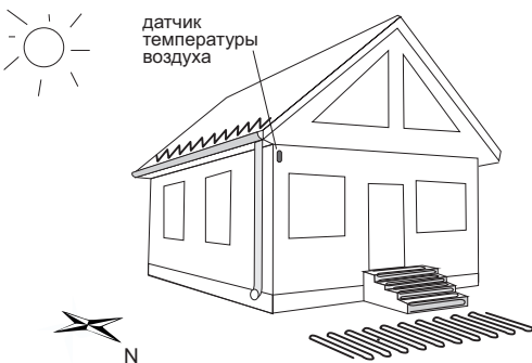
Рисунок 1. Монтаж датчика температуры воздуха
